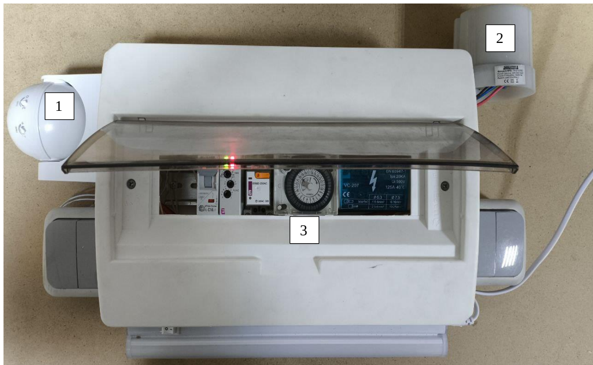
Рисунок 1. Лабораторний стенд для імітації роботи автоматизованих систем освітлення
