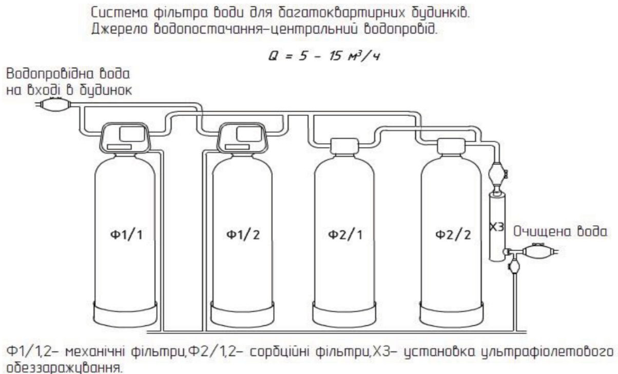
Рис. 1. Схема фільтра води для багатоквартирних будинків.
