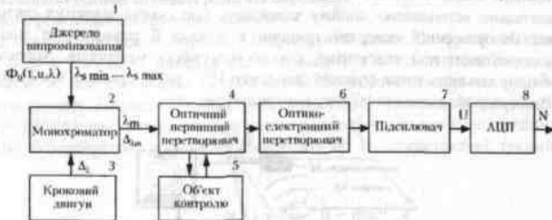
Рис. 1. Загальна структурна схема одноканального засобу вимірювань спектрів дифузного відбивання
