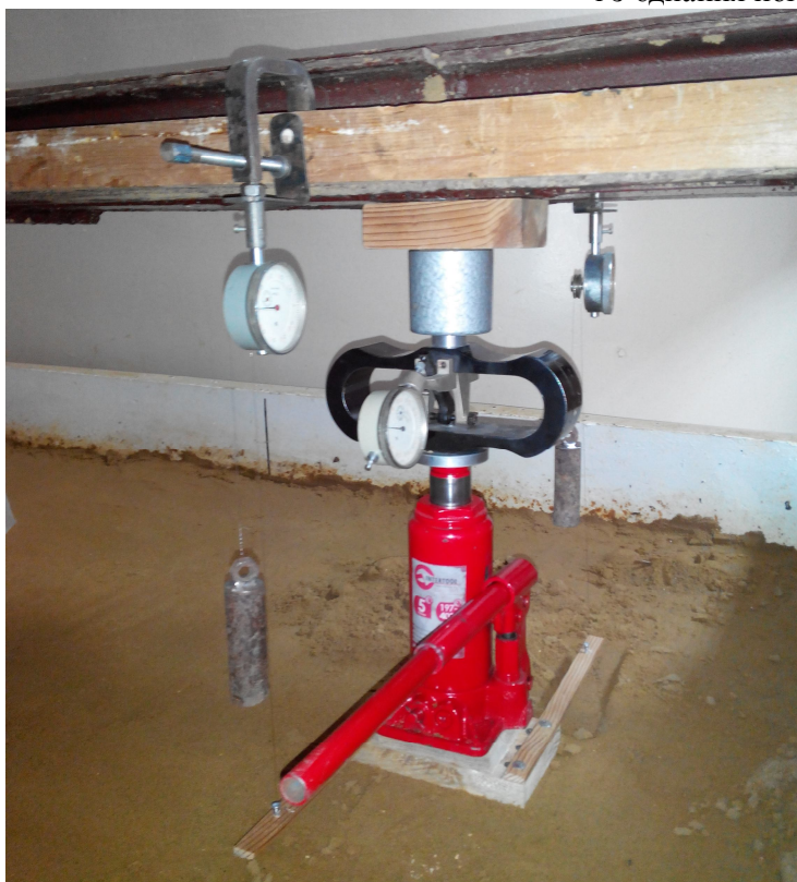
Рис. 3. Схема установки для випробування при відстані між шлицями 6d
