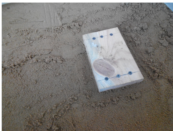
Рис. 2. Встановлення ростверку і з'єднання його з шлицями
