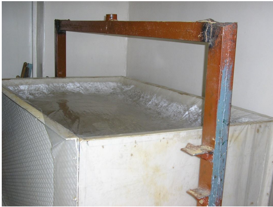
Рис. 1. Лоток з ущільненим піском
