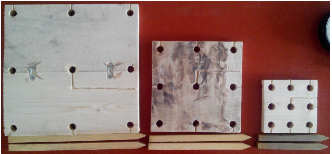
Рис. 2. Моделі ростверків та палів
