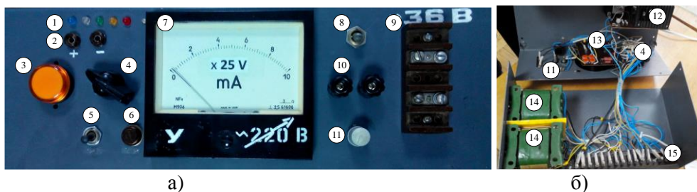
Рис. 1. Зовнішній вигляд універсального блоку живлення: а) передня панель; б) внутрішня будова
