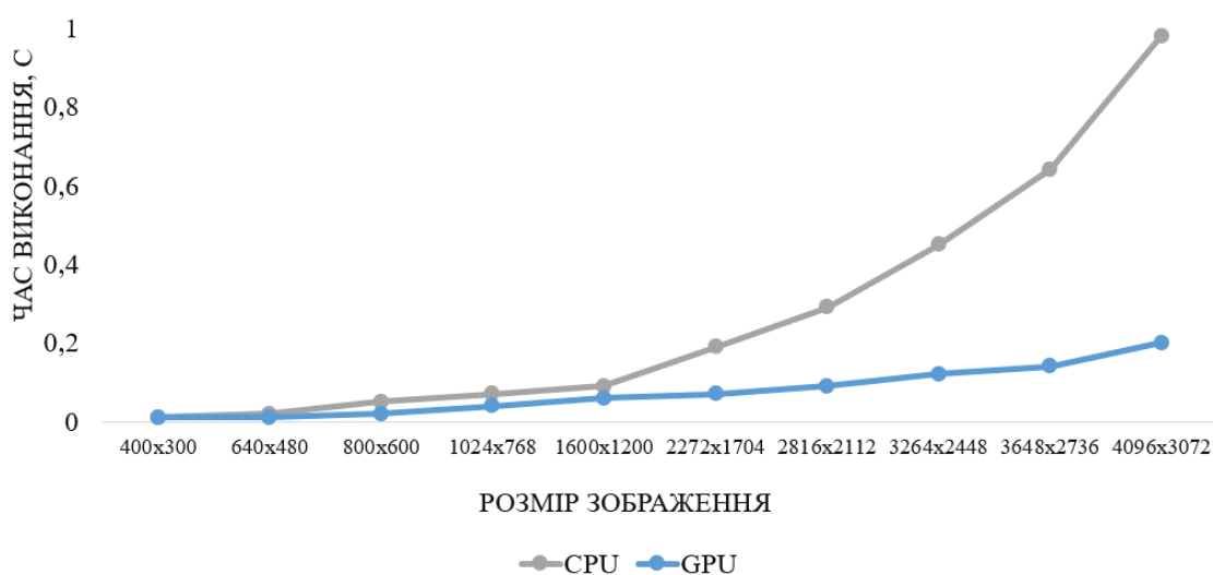
Рис. 4. Порівняння швидкості роботи алгоритму еквалізації гістограми зображення на CPU- та GPU-орієнтованих платформах
