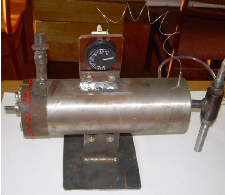
Рисунок 1 - Установа для газодинамічного нанесення функціональних покриттів. 1 – нагрівач повітря. 2 – розпилювач порошку
