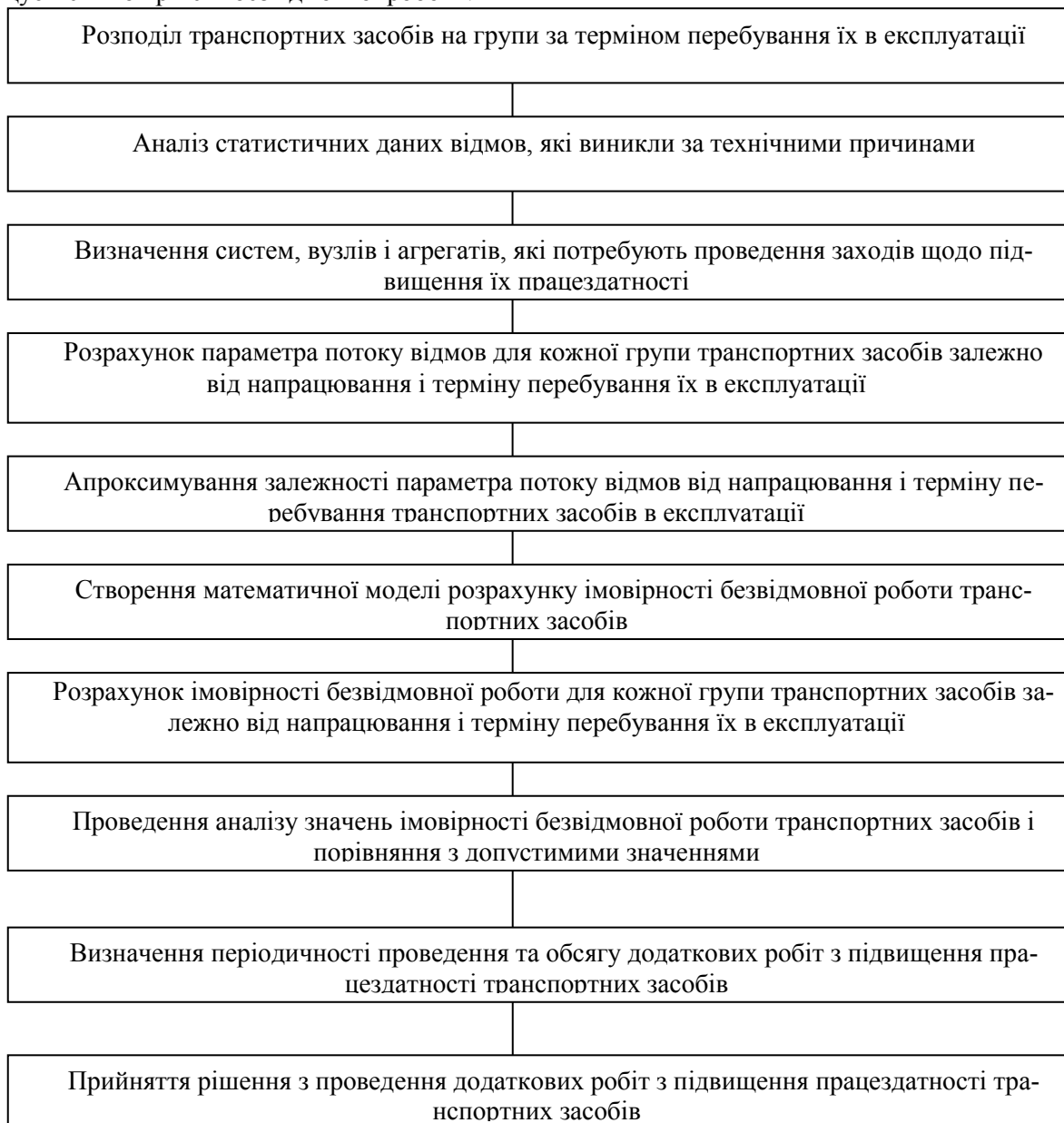
Рис. 3.1. Етапи реалізації методики підвищення ефективності функціонування системи технічного обслуговування і ремонту транспортних засобів
