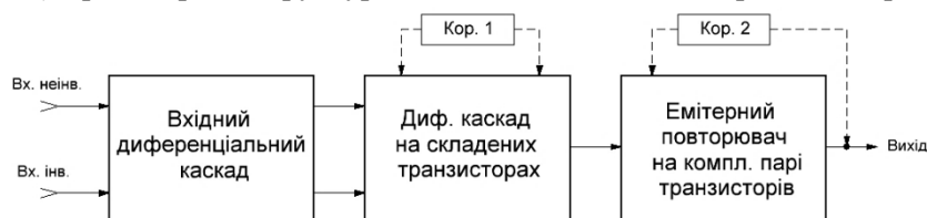
Рис.1 – Структурна схема підсилювача 153УД1.
