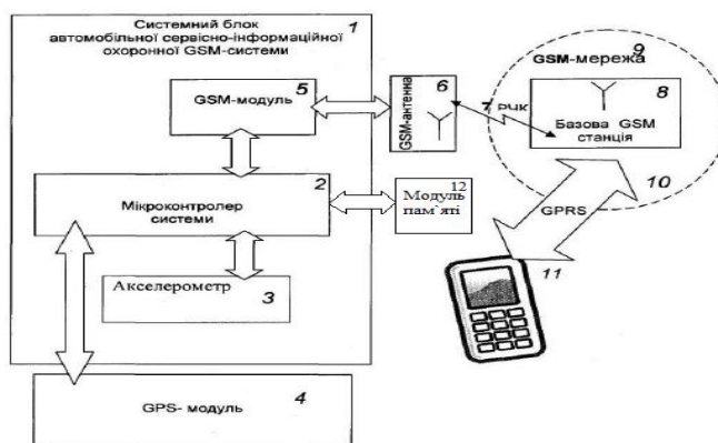
Рис. 1. Пристрій для відслідковування положення об'єктів на основі GPS
