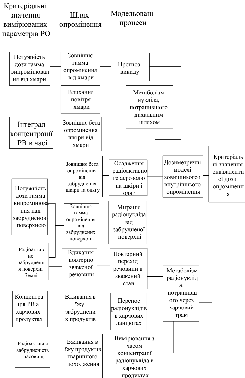
Рис. 2.11 - Блок-схема шляхів опромінення і модельованих процесів.
