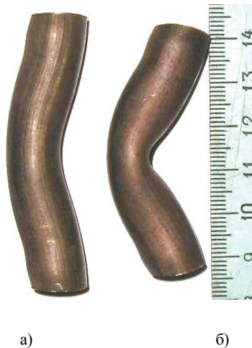
Рис. 7. Виріб: а — без істотної овалізації; б — зі значним відхиленням від круглої форми (матеріал — латунь Л98)
