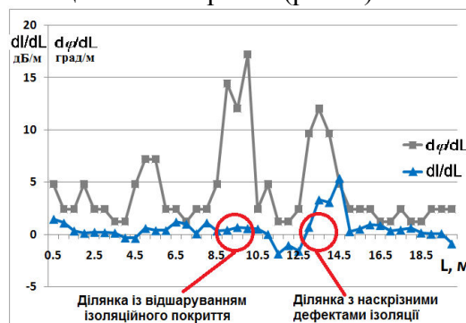
Рис. 7. Зіставлення результатів вимірювання двох інформативних параметрів на ділянці підземного нафтогазопроводу (загасання сигналу та зміна зсуву фази)
