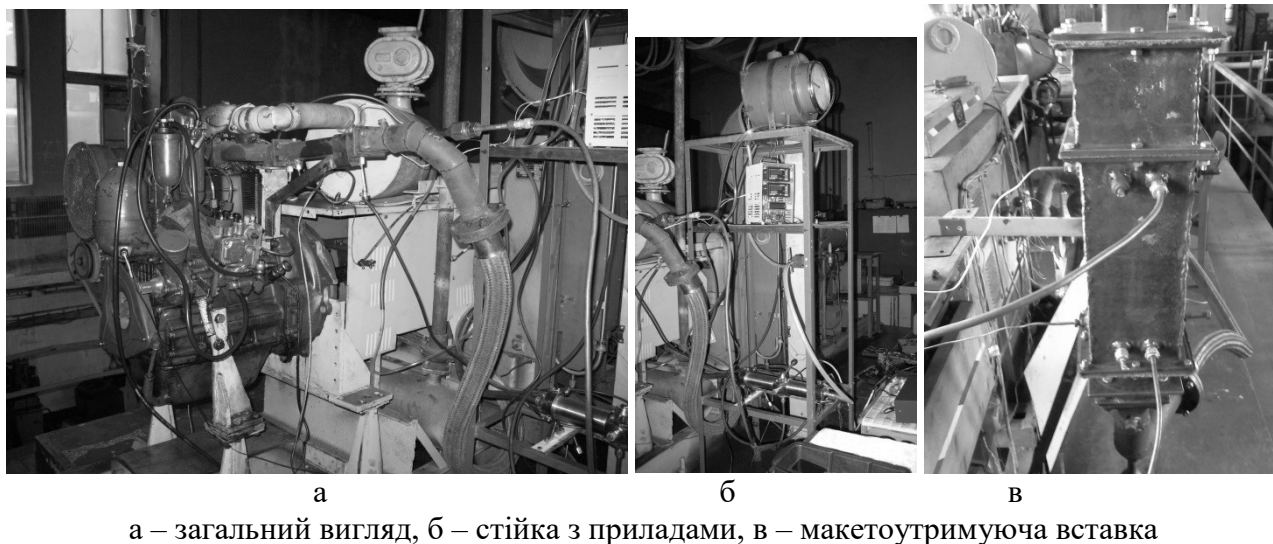
Рис. 2 – Модернізована випускная система МВС, обладнана МВ і системою відбору проб ВГ на токсичність і димність
