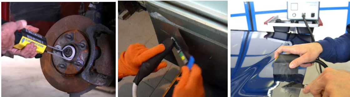
Рис. 4 – Індукційний нагрів в ремонтних технологіях автотранспорту
