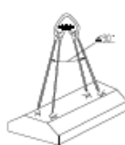
Схема стропування фундаментних плит
