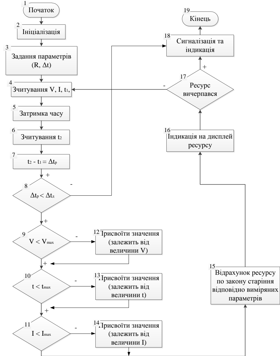
Алгоритм роботи пристрою діагностики тягового двигуна
