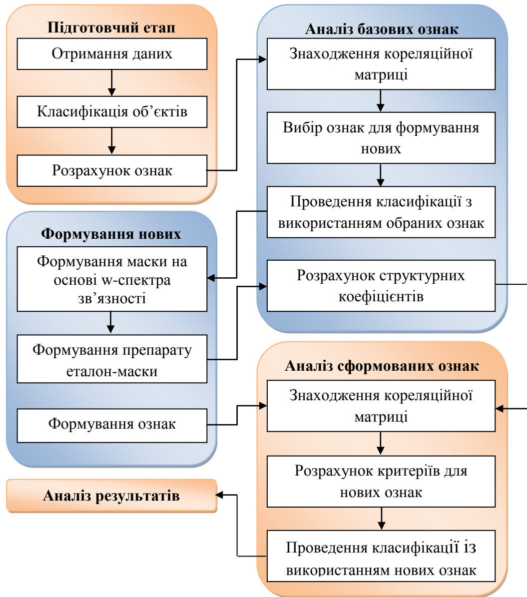
Рисунок 6 – Схема алгоритму роботи системи для оцінювання мікроциркуляції судин ока
