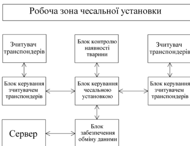
Рисунок 8 – Структурна схема системи радіочастотної ідентифікації нерухомих тварин для чесальної установки
