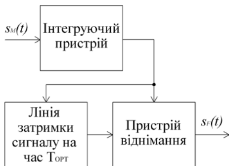
Рисунок 4 – Структурна схема лінійного оптимального фільтра для прямокутного імпульсу тривалістю T_{OPT}
