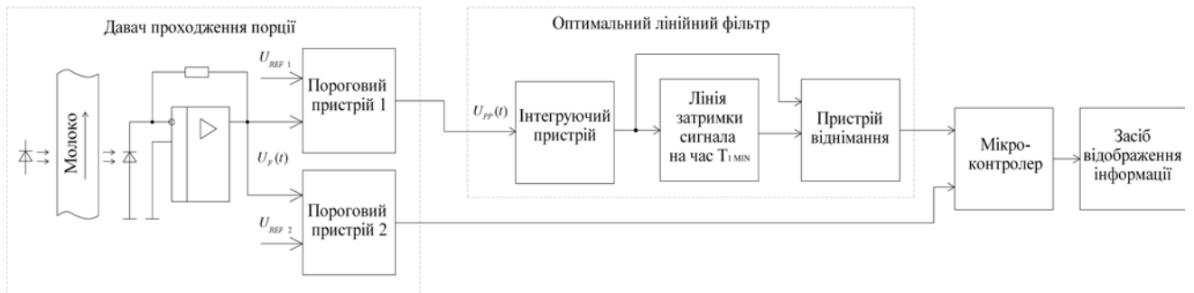
Рисунок 7 – Функціональна схема лічильника порцій молока для стійлової доїльної установки з використанням оптимальної лінійної фільтрації та функцією виявлення води у молоці
