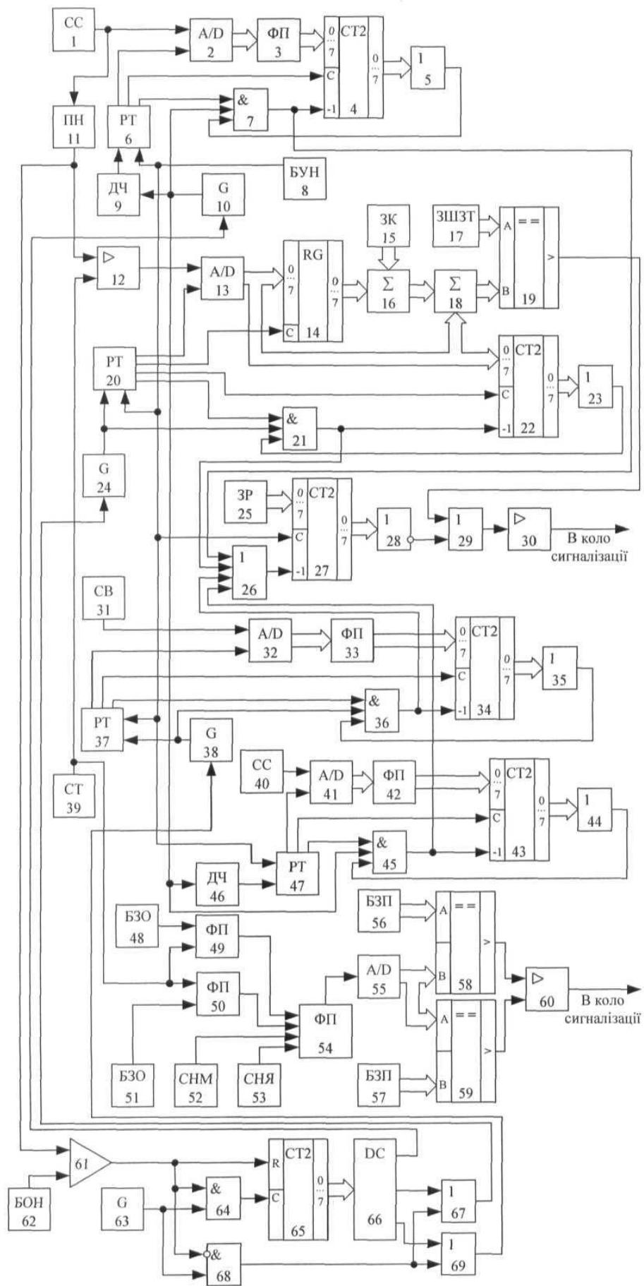
Корисна модель належить до області електротехніки і може бути використана для контролю роботи тягових двигунів постійного струму трамваїв.
