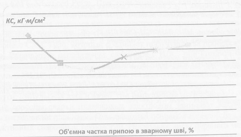
Рис. 7. Залежність ударної в'язкості зварного шва від об'ємної частки припою у ньому
