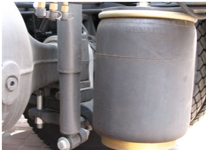
Рисунок 1.4 – Пневматичний балон сідлового тягача
