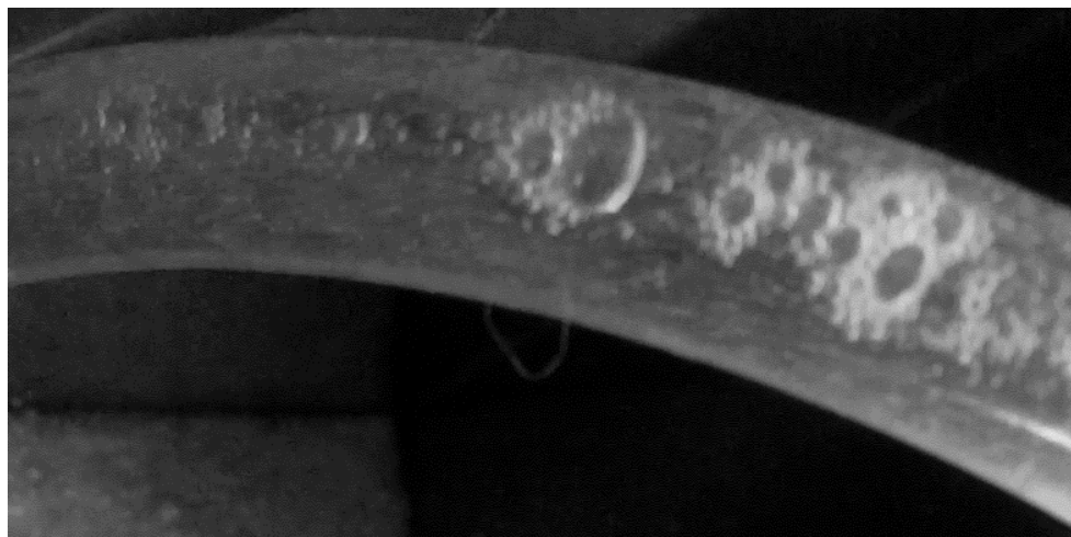
Рисунок 3 – Структура потоку в прозорому трубопроводі. Спостерігається наявність бульбашок повітря, які переносяться з камери нагнітання
