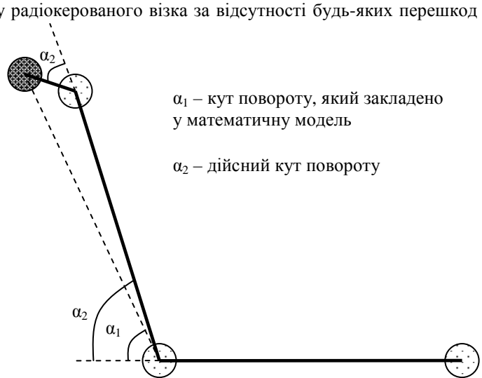
Рисунок 1 – Приклад тестування реального кута повороту радіокерованого візка
