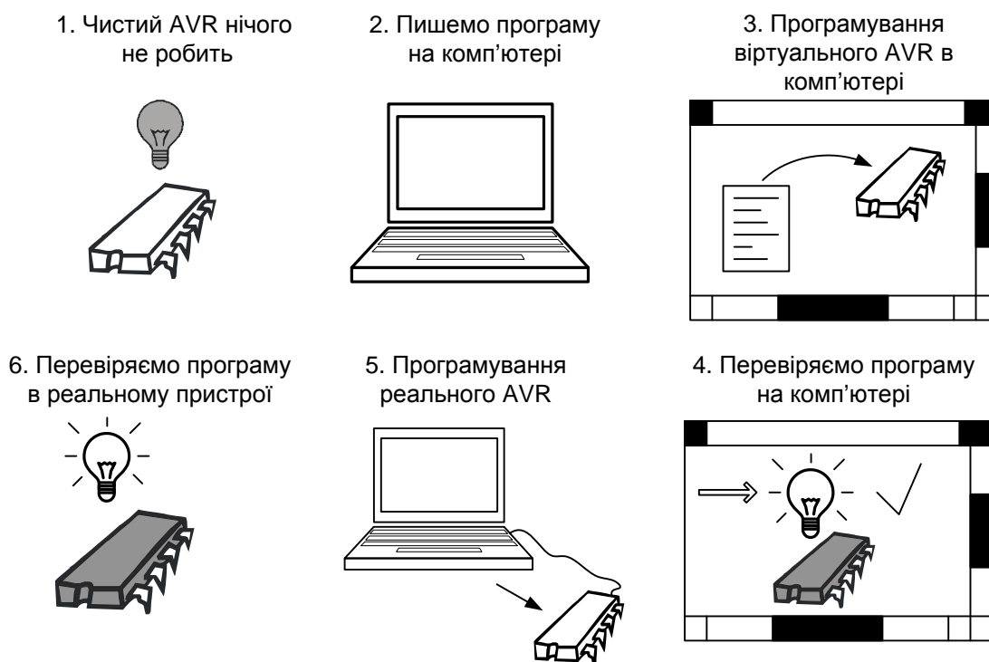
Рисунок В.1 – Етапи розробки програмного забезпечення мікроконтролерів AVR
