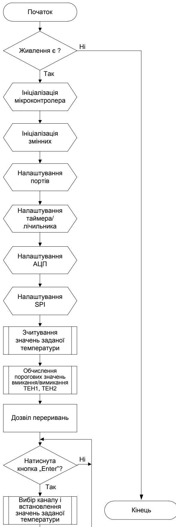
Рисунок 3.16 – Схема алгоритму основної програми мікроконтролера
