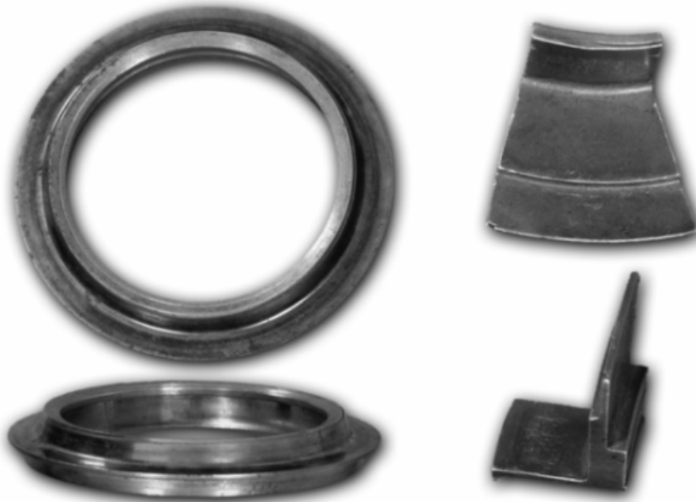
Рис. 6. Вироби, отримані з використанням технологічних схем переформування, осаджування та зворотного витискування кільцевих заготовок торцевим розкочуванням
