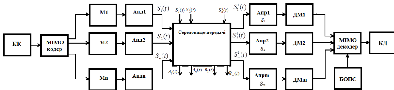
Рис. 1. Схема безпроводного каналу стандарту 802.11 з використанням технології MIMO
