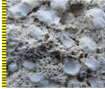
Рис. 6. Структура ячеистого композита комплексной поризации
