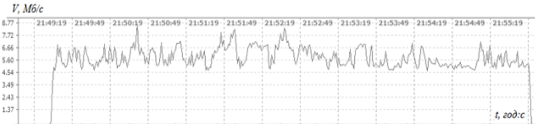
Рис. 2. Часові залежності ефективної швидкості передачі для каналу шириною 20 МГц при: прямій видимості (а); наявності перешкиди П1 (б); наявності перешкиди П1 та П2 (в); наявності перешкиди П2 та П2 (г)
