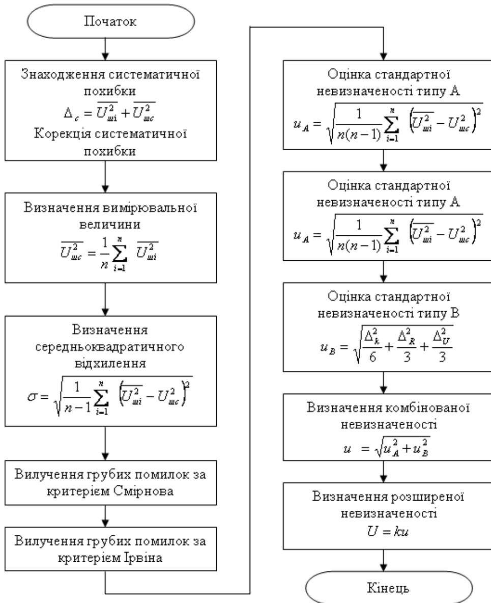
Рис. 1. Алгоритм оцінки невизначеності вимірювання інформативного параметра для засобу контролю виробів електронної техніки за рівнем власних шумів
