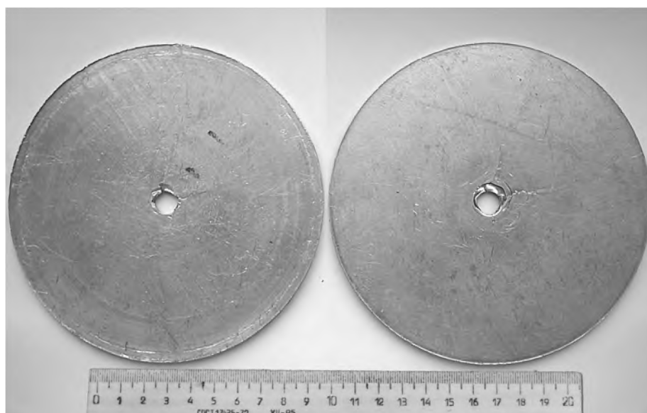
Рис. 4.26. Заготовка до (а) і після (б) процесу переформування із від'ємним зміщенням валка
