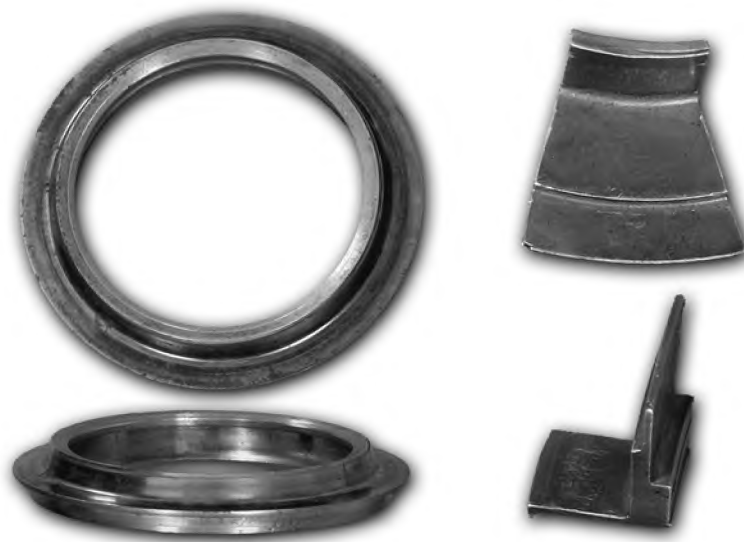
Рис. 3.5. Деталі, що виготовлені холодним торцевим розкочуванням циліндричним валком
