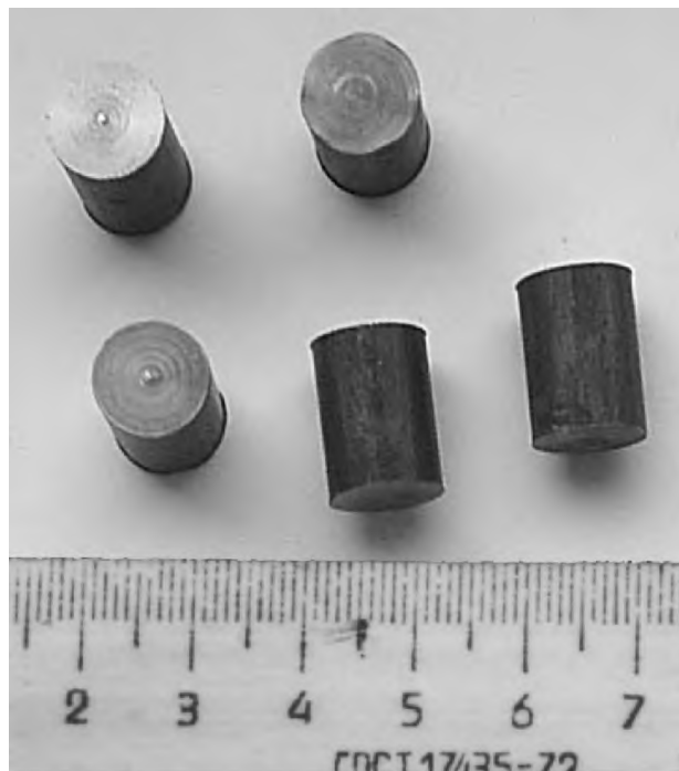
Рис. 4.11. Зразки для випробовування на стиск
