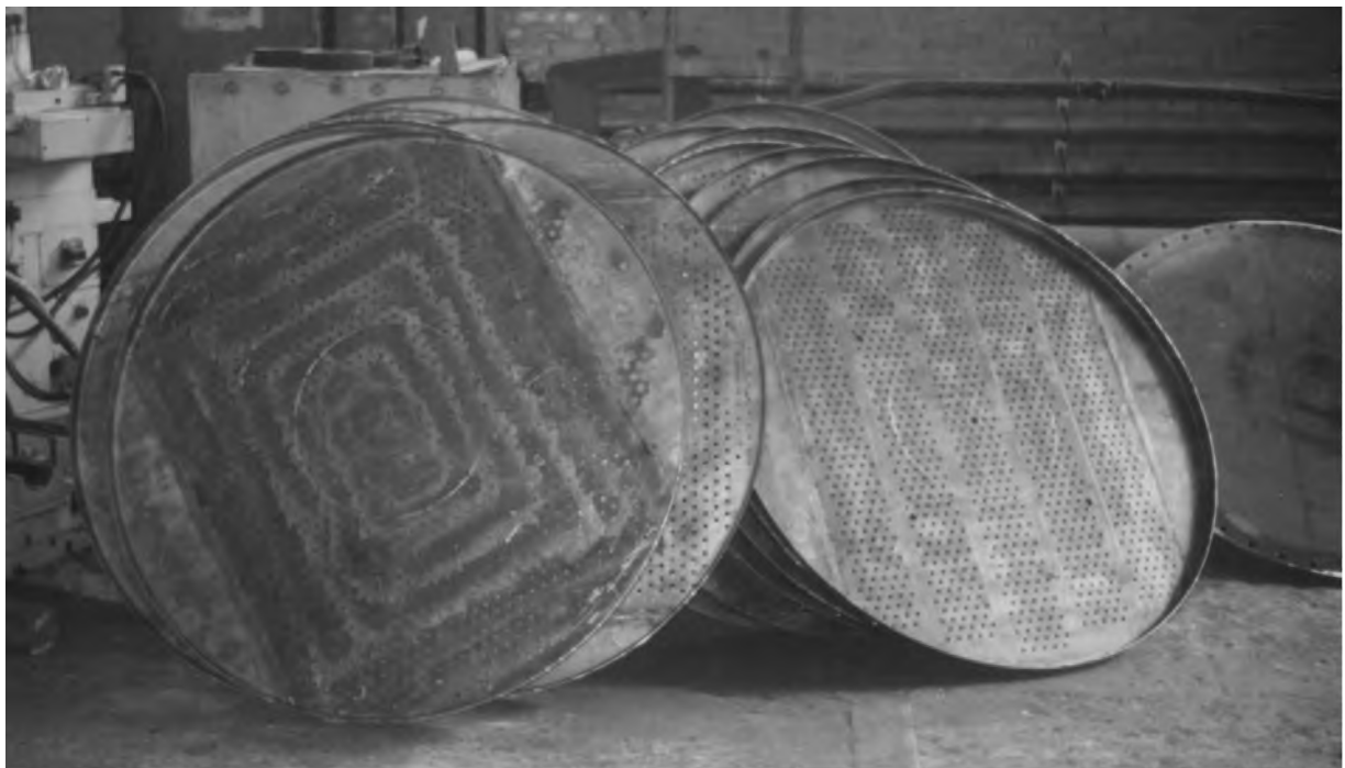
Рис. 4.17. Вироби, отримані ротаційною витяжкою конічним валком
