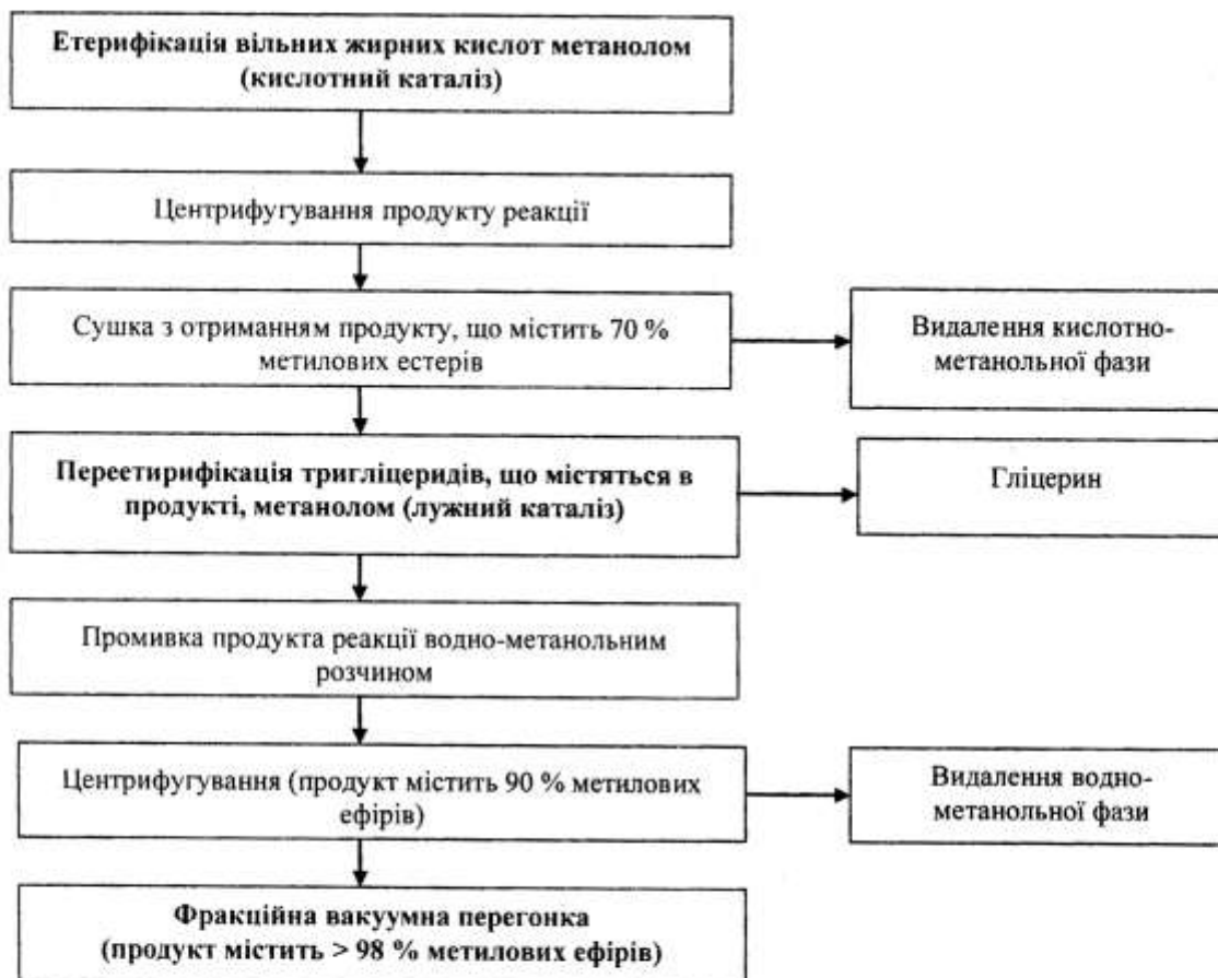
Рисунок 1 – Схема одержання біодизеля з відходів виробництва олії (соапстоків)
