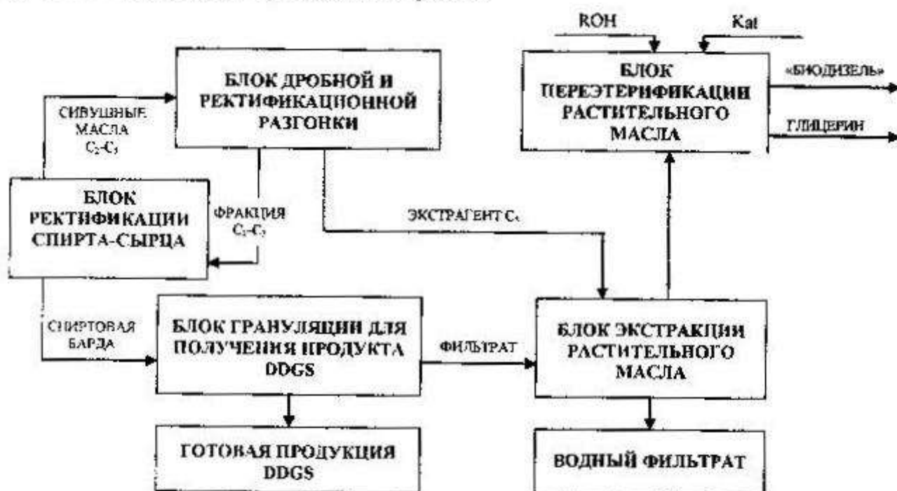
Рис. 1. – Принципиальная технологическая схема получения альтернативного топлива к дизельным двигателям внутреннего сгорания («Биодизель»)
