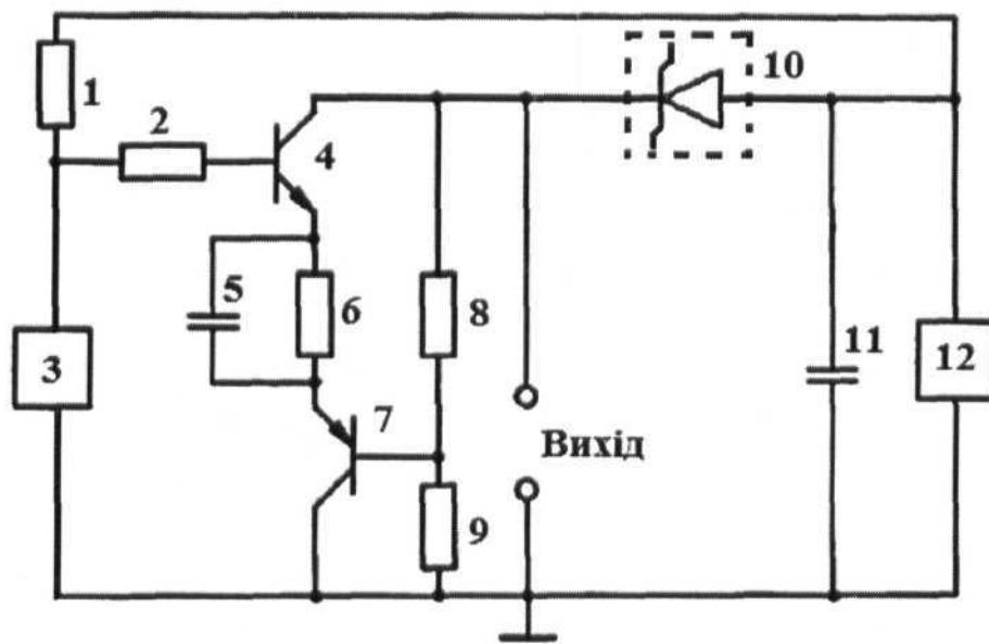
Корисна модель належить до області контрольно-вимірювальної техніки і може бути використана як датчик освітленості в різноманітних пристроях автоматичного керування технологічними процесами.
