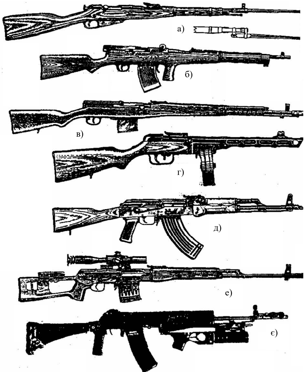
Рис. 2.6. Російська стрілецька зброя ХХ в.: а – магазинна гвинтівка Мосіна (1891 р.); б – автоматична гвинтівка Федорова (1916 р.); в – самозарядна гвинтівка Токарева СВТ-40; г – пістолет-кулемет Шпагіна ППШ-41; д – автомат Калашникова АК-47; е – снайперська автоматична гвинтівка Драгунова СВД; е – автомат Ніконова АН-94
