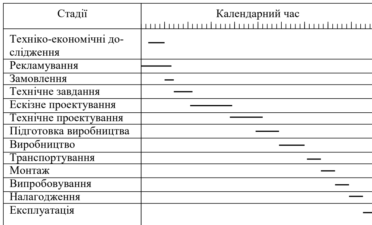
Рис. 10.2. Спрощений план-графік стадій створення та використання ТС одиничного виробництва
