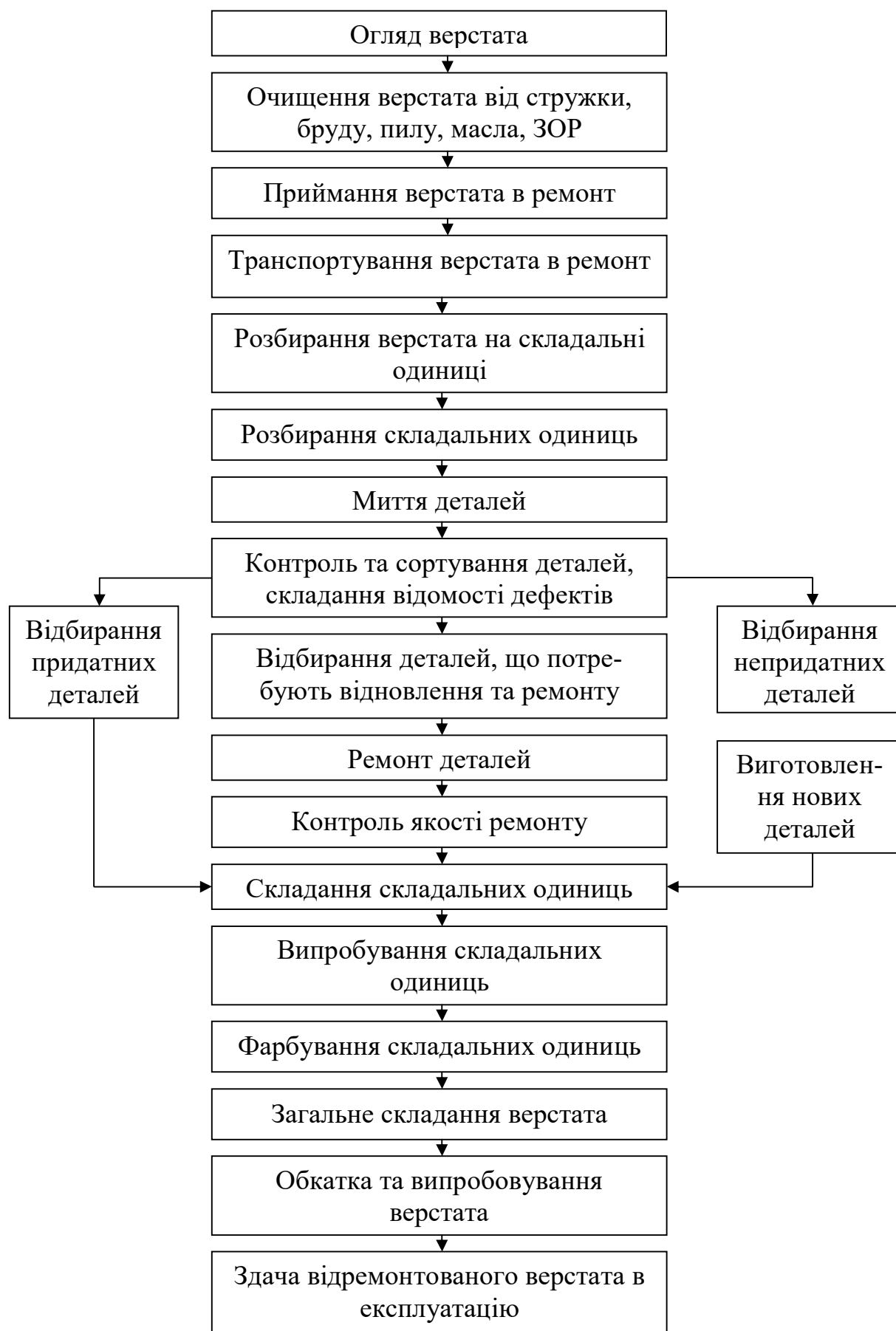
Рис. 1.1. Схема технологічного процесу капітального ремонту верстатного комплексу
