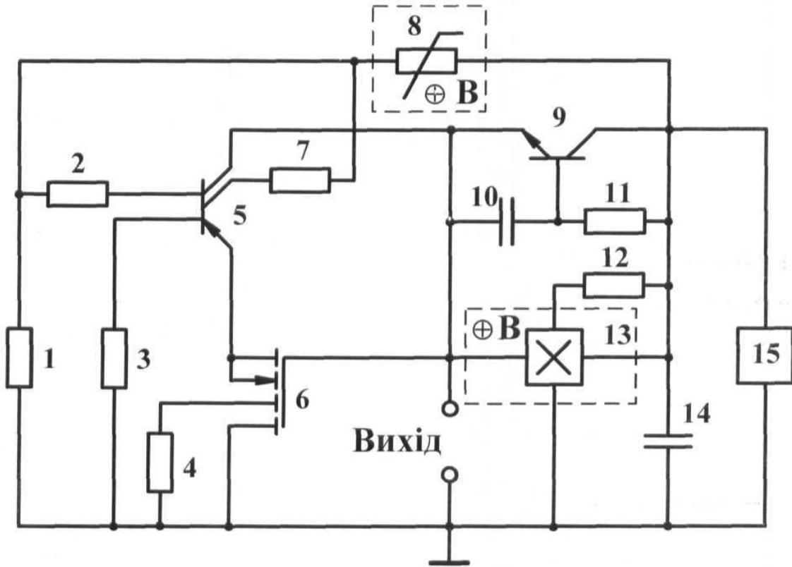
Корисна модель належить до області контрольної-вимірювальної техніки на базі напівпровідникової електроніки і може бути використана для вимірювання індукції магнітного поля в системах контролю та керування технологічними процесами.
