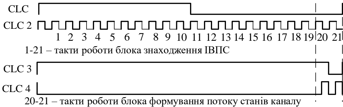
Рисунок 6 – Часові діаграми пристрою оцінювання ПБП
