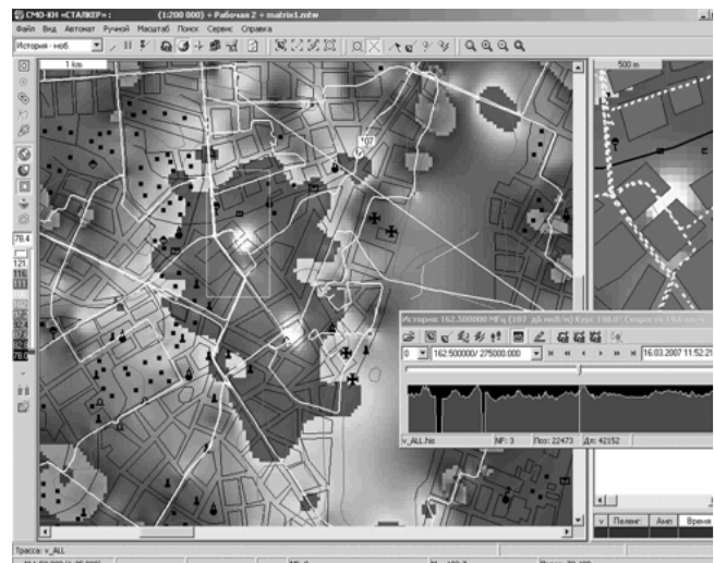
Рисунок 3 - Відображення результатів вимірів напруженості поля на карті місцевості
