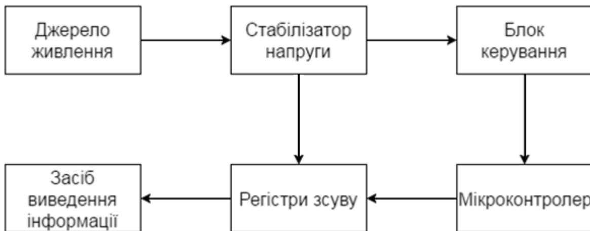
Рис.1. Пристрій для завантаження міні-ігор на основі мікроконтролеру PIC16F688
