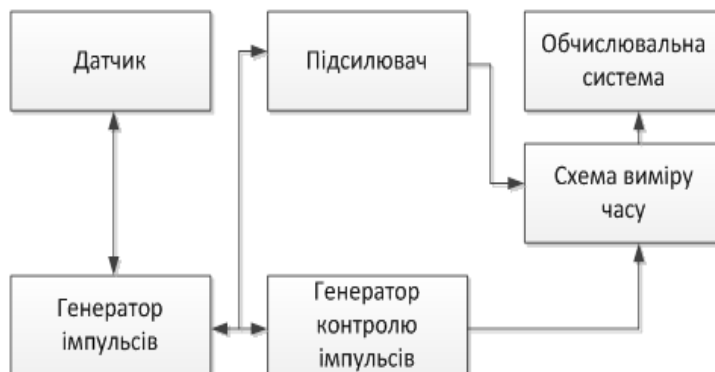
Рисунок 2 - Структурна схема ультразвукового рівнеміра
