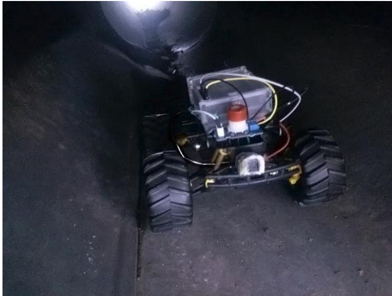
Рис. 2. Моніторинг зовнішнього стану внутрішньої поверхні водопровідної труби з використанням створеного авторами безпілотного автомобільного дрону
