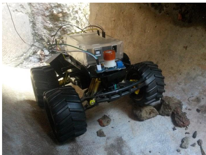
Рис. 3. Прокладання телекомунікаційного кабелю у складно доступних умовах з використанням створеного авторами безпілотного автомобільного дрону
