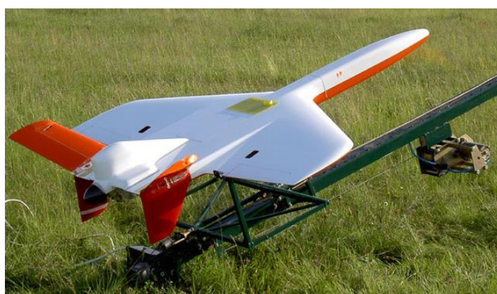
Рис. 4. Український БПЛА R-100 для розпилення реагенту для розгону хмар
