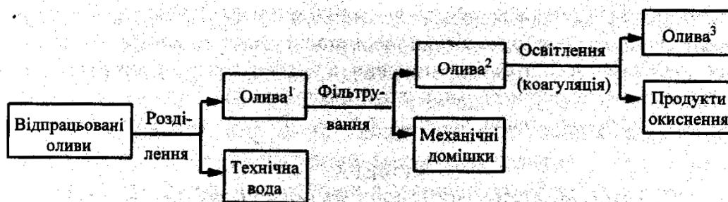
Процес регенерації включав фізичні операції відділення води, механічних домішок та фізико-хімічні операції освітлення відпрацьованих олив від продуктів окиснення коагулянтами. У залежності від експлуатаційних вимог очищена Олива<sup>3</sup> може використовуватись безпосередньо в технологічних процесах, піддаватись ректифікаційній розгонці або модифікуватись додатками.
