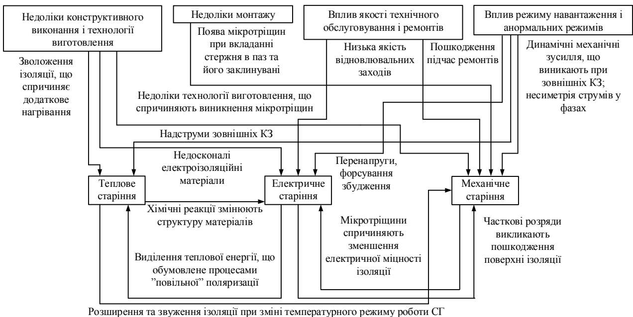
Рисунок 1 – Вплив різного роду факторів на ізоляцію обмотки статора СГ
