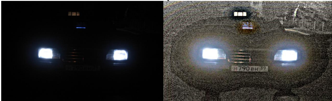
Рисунок 2 – Результати оброблення зображень алгоритмом Retinex, а) вхідне зображення, б) зображення із вирівняним освітленням
