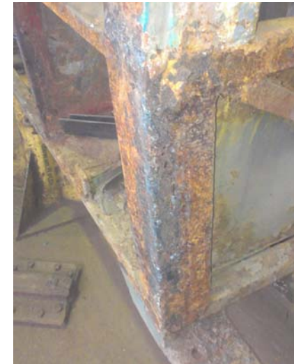
Рисунок 2 – Спрацьована рама тролейбуса після заняття листової оболонки
