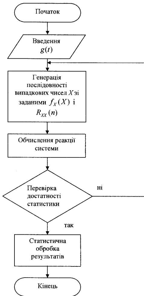
Рисунок 1.7 – Структурна схема алгоритму моделювання нестационарної системи
