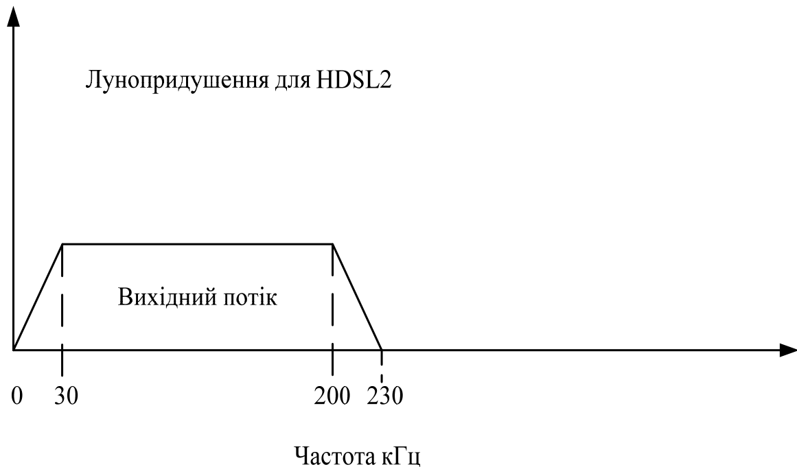
Рисунок 4.7 – Принципи FDM і лунопридушення HDSL2
